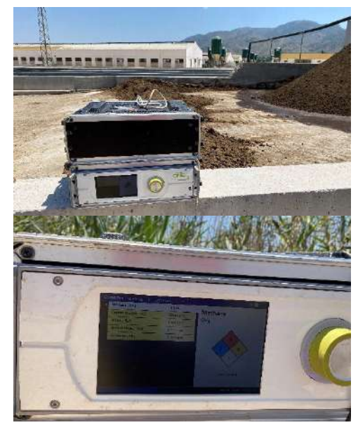
Equipo analizador de gases (GASERAONE)
