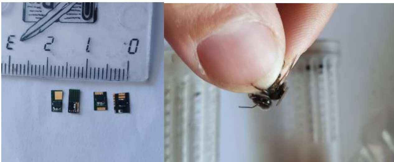
Detalle del nuevo sustrato de poliamida que se ensayó, en formas rectangulares y cuadradas.
