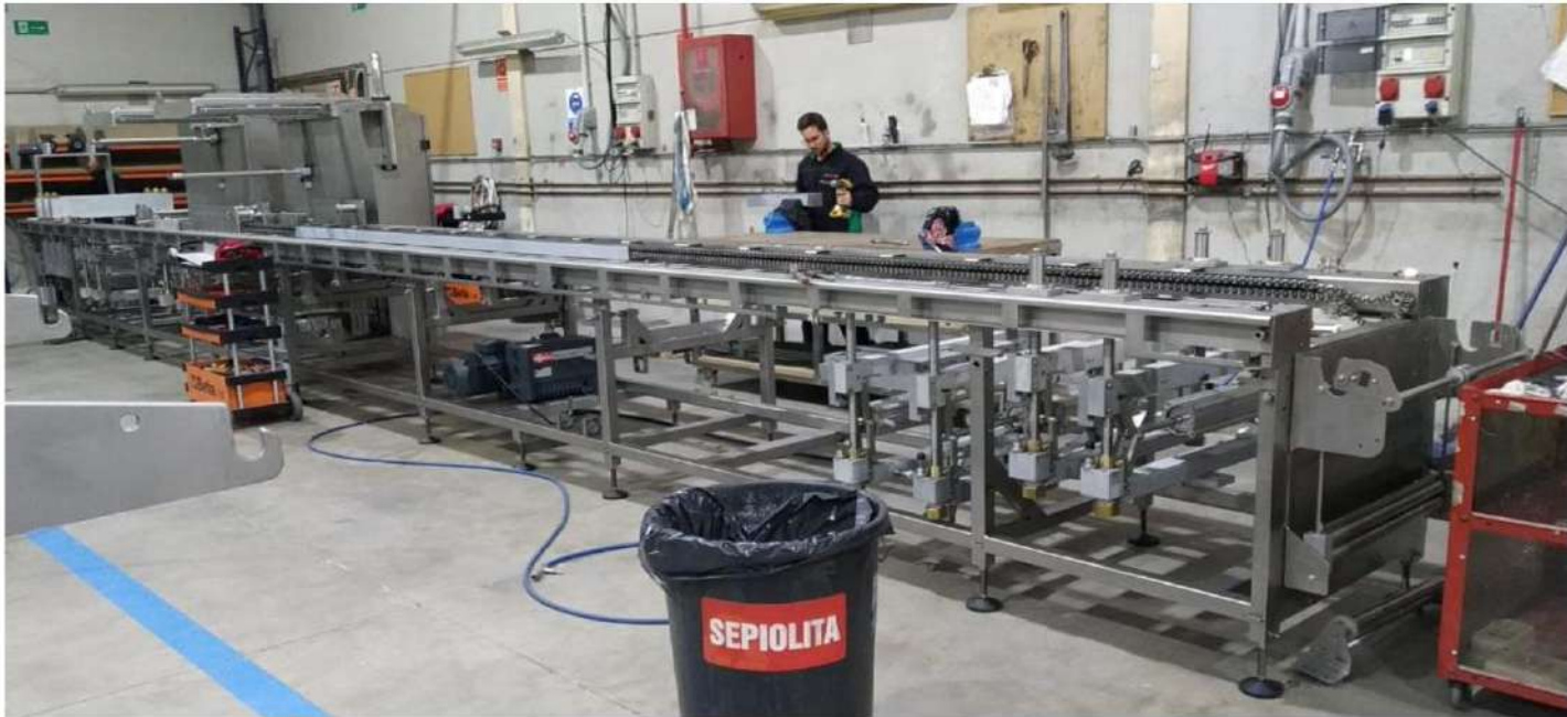
Máquina termoformadora en construcción preparada para adaptación para fabricación de módulos
